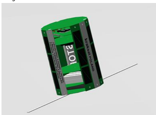
Rys. 1 Model satelity wykonany w programie Inventor.
