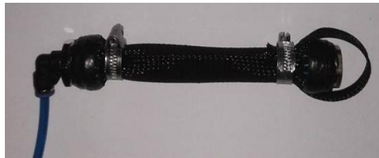
Rys. 3 Wykonany prototyp mięśnia pneumatycznego
