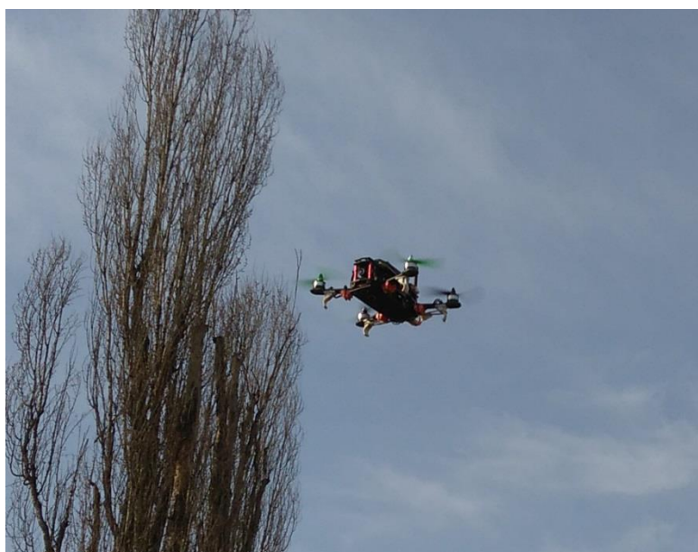
Rys. 1 Mały dron sportowy z kontrolerem APM 2.6 wykorzystywany do wstępnych testów. Docelowy dron będzie większy i sterowany kontrolerem wyższej klasy - Pixhawk.
