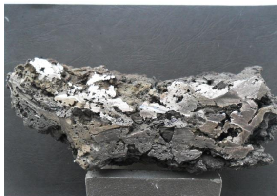
Rys. 6 Przekrój łupki żelaza dymarskiego
