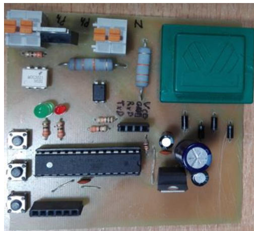
Rys. 1 Zdjęcie prototypu jednofazowego sterownika mocy.
