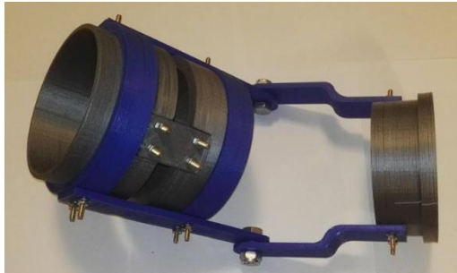
Rys. 2 Wykonany w technologii druku 3D prototyp demonstratora
