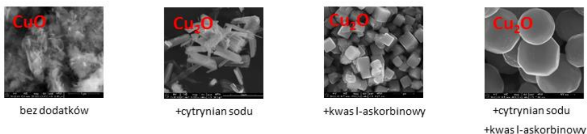
Rys. 1 Obraz SEM poliedrycznych nanostruktur na bazie Cu 2 -xO
